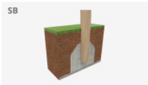
Befestigung eines Holzträgers in einer Rasenfläche
